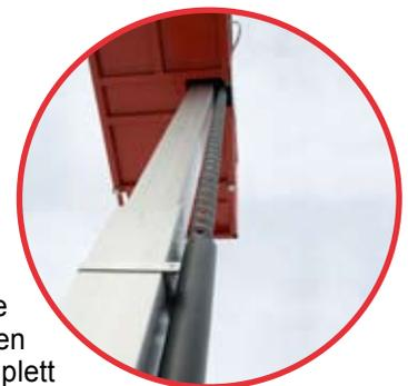
Das von der Firma BRAVI PLATFORMS revolutionäre Hebelsystem wurde für alle Modellen ihrer Hebebühnen gedacht und realisiert, und ist eine gründliche Änderung in diesem Bereich. Die Säule ist aus einer speziellen fließgepressten Aluminium Legierung und ist komplett wartungsfrei. Keine Ketten zum nachprüfen jedes Jahr – Kein Fett auf der Säule – Keine Wartung ist gefordert!
