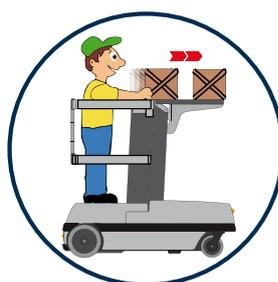
Diese Ladefläche ist bei maximaler Hubhöhe gleich so hoch wie die Säule. Dies ist sehr nützlich, weil auch die schwereren Pakete mit der Säule als Grundlage geschoben werden können.
